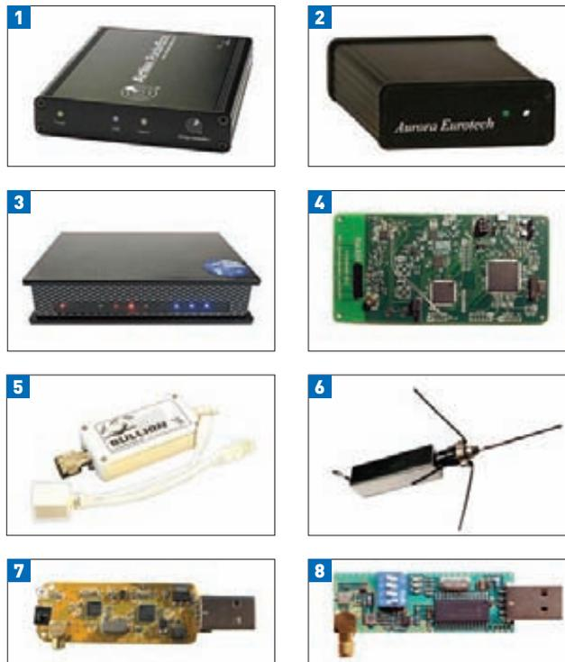
1) AirNav RadarBox; 2) Aurora Eurotech; 3) Kinetic Avionic SBS-1; 4) HackRF; 5) microADSB-IP; 6) miniADSB; 7) RTL-SDR; 8) microADSB
